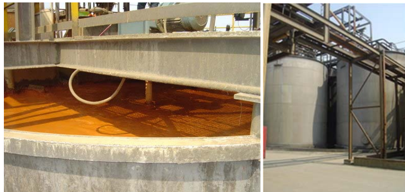
Figura 12. Bioreactoare folosite în procesul de biosolubilizare - tehnologie implementată de compania canadiană BacTech Environmental // Slika 12. Bioreaktori koji se koriste u procesu biosolubilizacije - tehnologija koju je implementirala kanadska kompanija BacTech Environmental (sursa // izvor: https://www.bactechgreen.com/bioleaching )
